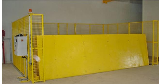
**Offene Bodenluke, Eingang zum Schleusenraum gesichert. Kranbedienung von der Seite vom Schaltschrank: Dank Gitter permanente Sichtkontrolle.**
