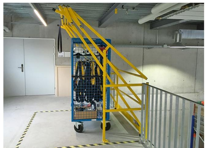
**Bodenmarkierung für Schwenkbereich**
