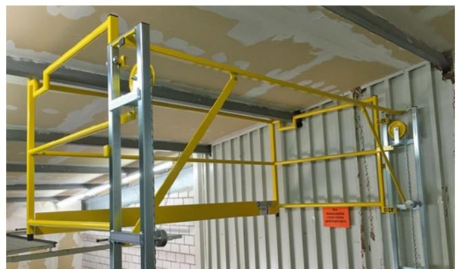
**Vorderer Korb an Dachträger angepasst für maximale Hubhöhe.**
