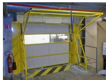
Sicherheitsschwenkschleuse: Zugang über die Bühne gesperrt. Warenübergabe mit Stapler
