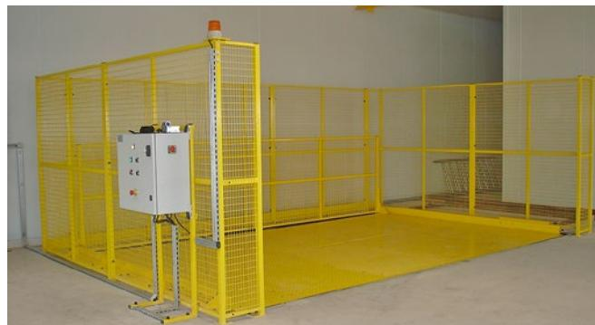
**Ansicht Bühne, geschlossene Bodenluke mit Schleusenraum fix. Zugang zum Schleusenraum frei. Für Arbeiten mit Kran.**
