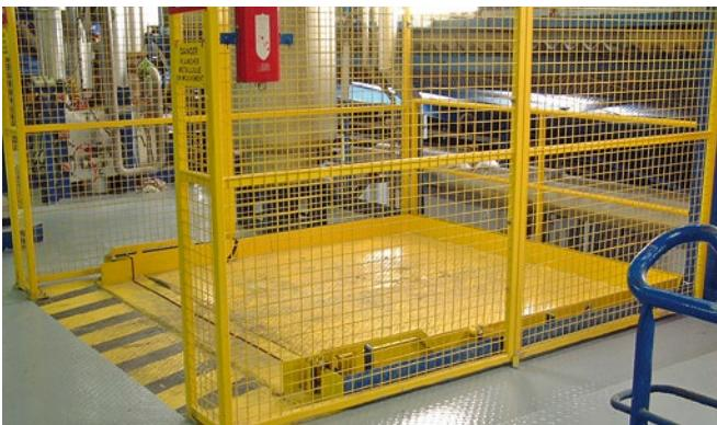
**Bodenluke, die gleichzeitig als Abstellfläche verwendet werden kann um mit dem Kran aus dem oberen Geschoss die Güter zu fassen.**
