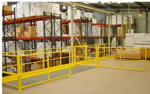
**Schleuse mit 2-flügeligen Toren. Abb.: 1 Flügel offen
