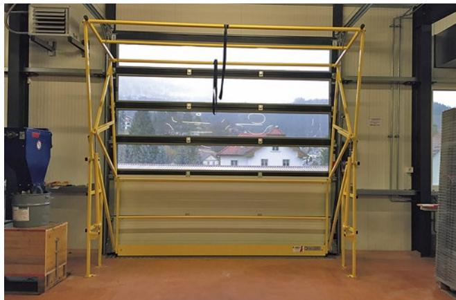
**Typ X: Die spezielle Konstruktion des Schwenkradius erlaubt die Höhenmaximierung des Schleusenraumes**
