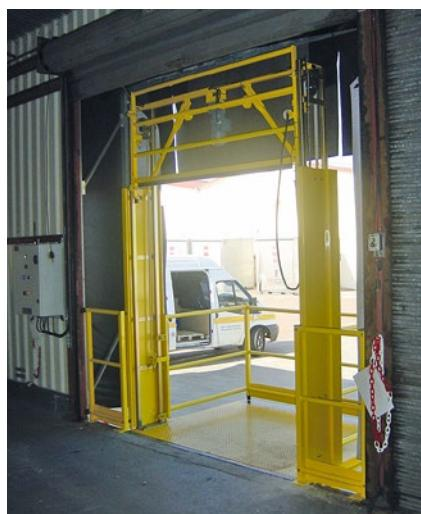
Gesicherter Warenaumschlag an Rampe mit Bühnenverlängerung. Ansicht vom Lager.
