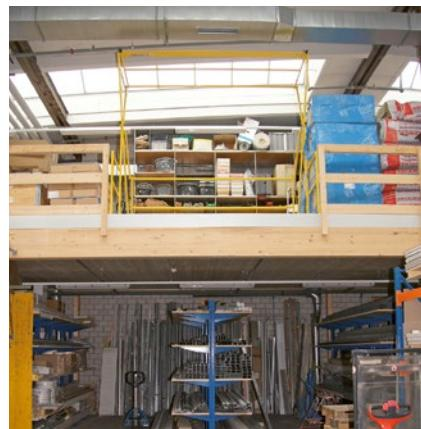
**Schleuse offen, frei für Beladung oder Entnahme mit Stapler.**
