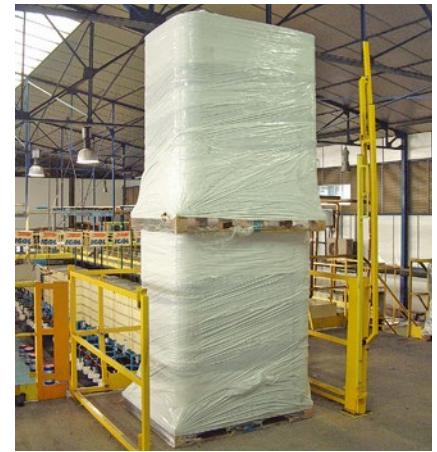
Abbildung L1D: Getriebe rechts, Barrieren falten sich rechts zusammen, gerade Entnahmee, Absturzkante gesichert. Alternativ Getriebe links.
