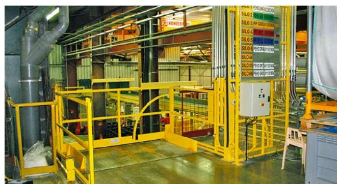
**Typ L4D: Geländer schwenkt um 90 Grad: Platzbedarf: Gesamtbreite =
