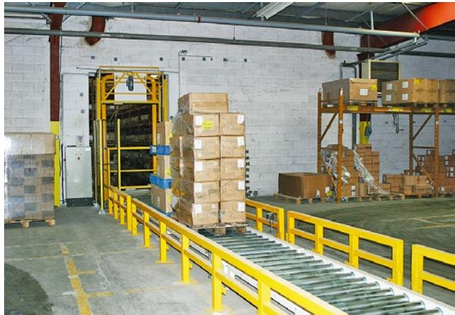
Wanddurchbruch zum Logistiklager: motorisch angetriebene Rollenbahn und Schleuse als Pufferzone für raschen Warenaumschlag.
