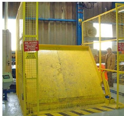
**Bodenluke im sich öffnenden Zustand, der Zugang zum Schleusenraum wird geschlossen. Kein Zutritt mehr möglich.**
