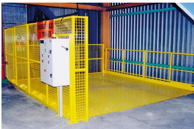
**Im geschlossenen Zustand ist die Bodenplatte befahrbar, dieses Beispiel mit 2To./m<sup>2</sup>**
