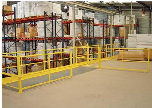
▲ Schleuse mit 2-flügeligen Toren. Abb.: 1 Flügel offen. Schiebetor geschlossen, Bühnenkante gesichert.
