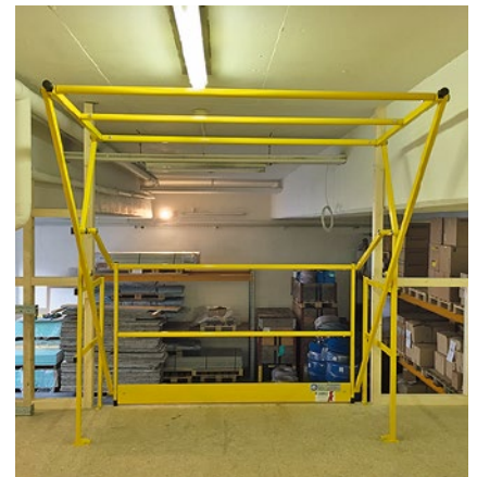
Geöffnetes Schleusengeländer – Bühnen- kante gesichert
