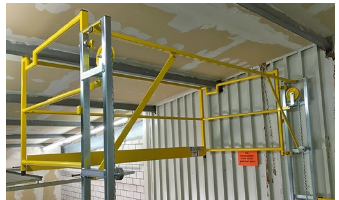
Vorderer Korb an Dachträger angepasst für maximale Hubhöhe. Corbeille avant sur le support de toit, adapté à la hauteur de levage maximale
