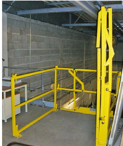
Typ L2D-BCR: Getriebe rechts, sehr geringe Raumhöhe. Besonderheit: komplett zusammenfaltend.
