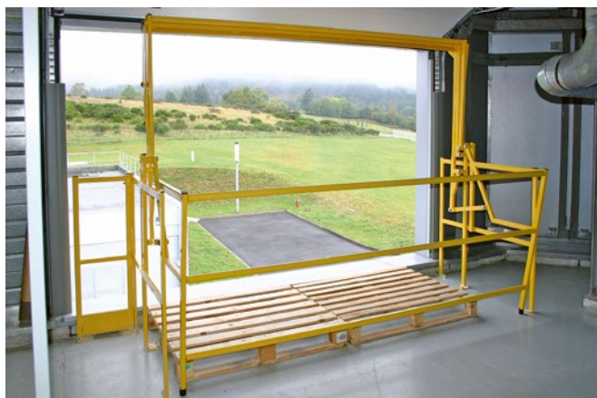
Das zurückgesetzte Geländer an der Vorderfront ermöglicht den ungehinderten Einsatz eines Sektionaltors. Dieses Sicherheits-schleusengeländer besteht auf der Rückseite aus einem Schleusengeländer Typ B und auf der Vorderseite aus einem Typ T. Baubreite ist bei 3300 mm begrenzt.
