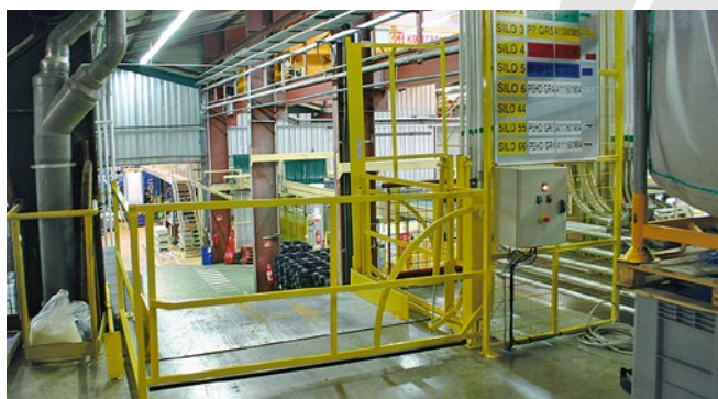
Typ L4D: Absturzkante frei für Belad / Entnahme Typ L4D: bord de la zone présentant un risque de chutes dégagé pour le chargement/déchargement
