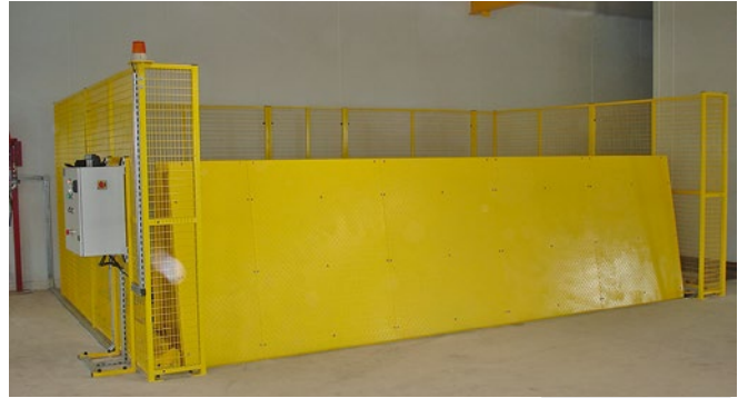
Offene Bodenluke, Eingang zum Schleusenraum gesichert. Kranbedienung von der Seite vom Schaltschrank: Dank Gitter permanente Sichtkontrolle. Trappe de plancher ouverte, entrée dans la zone de sas sécurisée. Commande de la grue à partir de la zone de l'armoire électrique : grâce à un contrôle visuel permanent par la grille.
