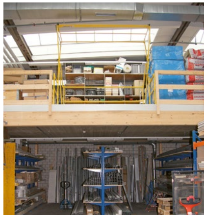
Schleuse offen, frei für Beladung oder Ent- nahme mit Stapler.
