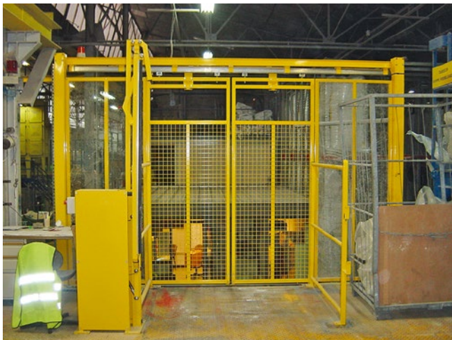
L2G-BCR-G: Absturzkannte mit vergitterten Schiebetoren, Anwendung geeignet bei Gütern wo Teile herunterfallen könnten.
