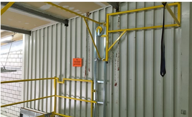
Kleinste Korbhöhe zur Bühne. Zum Unterlaufen im offenen Zustand. Hauteur de corbeille minimale par rapport à la plate-forme. Permet de passer en dessous en position ouverte
