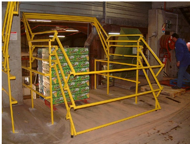
Typ T2L-SO (Tiefe Ausführung) in Chromnickelstahl (CNS) oder feuerverzinkt erhältlich
