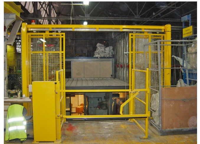
L2G-BCR-G: Klappschranke elektrisch betrieben, Bühnenseite mit Auffahrschutz-Sensor.
