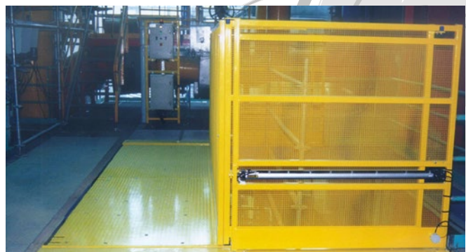
Bodenluke geschlossen: Schleusenraum zusammen gefahren. Durchgang auf der Bühne maximiert. Trappe de chargement fermée : zone de sas actionnée en même temps. Passage sur la plate-forme augmenté.
