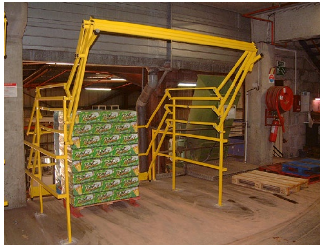
Typ T2L-SO: Sonderausführung für eingeschränkte Höhe bei Palettenübergabe. Bühnenseite: höhere Öffnung bei der Bereitstellung
