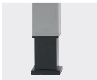
Kunststofffuß: Stufenlos höheneinrichtbar von 680–760 mm durch Drehen eines schwarzen Kunststoffstellgleiters mit Verstellkala.
