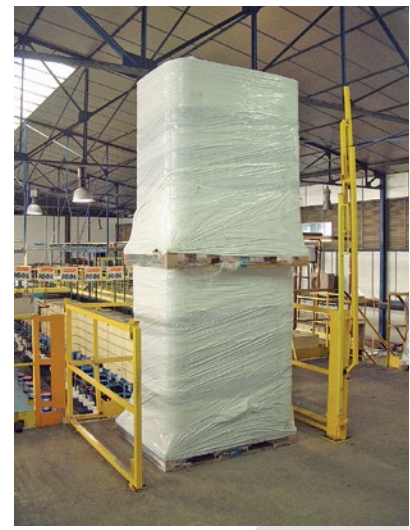
▲ Typ L – besonders geeignet für hohe Güter und Kranumschlag
