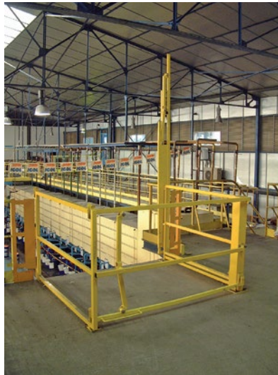
▲ Typ L – besonders geeignet für hohe Güter und Kranumschlag
