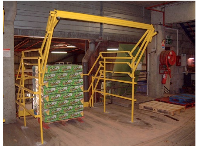
▲ Typ T-SO: Sonderausführung für eingeschränkte Höhe bei Paletten-übergabe. Bühnenseite: höhere Öffnung bei der Bereitstellung
