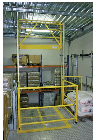
Schleuse offen für Warenentnahme ▲
