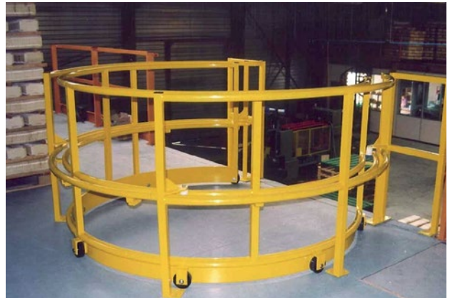
▲ Schleuse offen für Warenentnahme
