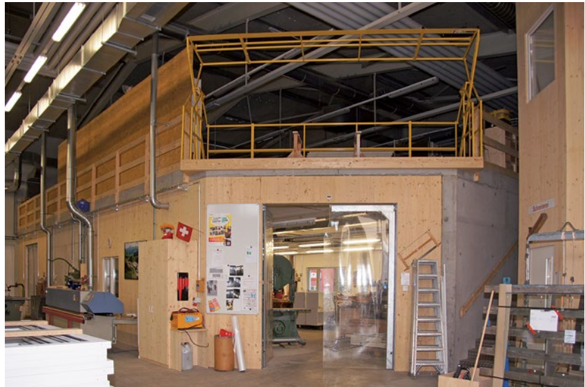
Schwingschleuse Länge 5.60 m, auch geeignet für Langgut-Umschlag ▲
