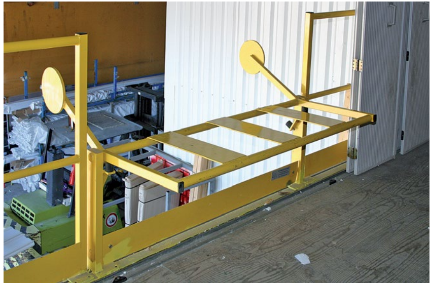
▲ Spezialausführung eines Klappsicherheitsgeländers. Geländer schwenkt automatisch in aufrechte Position, gesichert gegen Schwenken nach Aussen.
