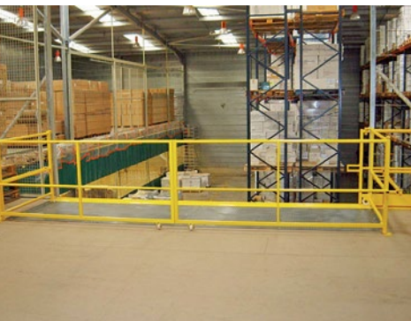
▲ Schleuse zur Bühne geschlossen (gesichert). Schiebetor offen
