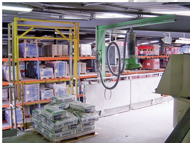
Bühnenkante gesichert, Klappgeländer offen ▲
