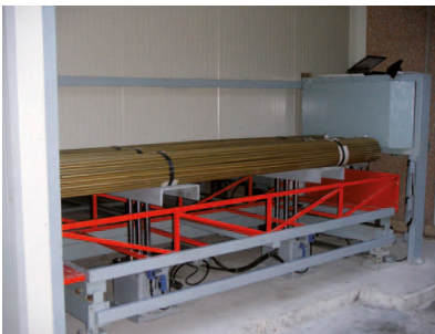
Ausgabe / Belad mit hydraulischem Hubtisch für Langgut Sortie / Chargé avec table de levage hydraulique pour charges longues
