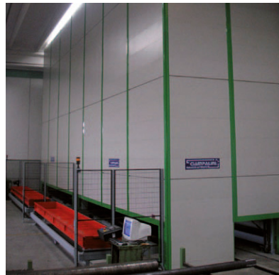
Zwei BI.MAG Anlagen mit 1 late- ralen Ausgabestelle Deux système BI.MAG à un sortie latérale
