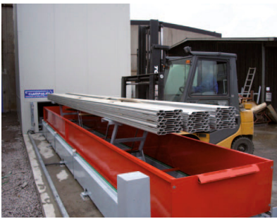
Lateraler Ausfahrtschlitten mit Scherenhub-Vorrichtung Sortie lateral avec ciseau
