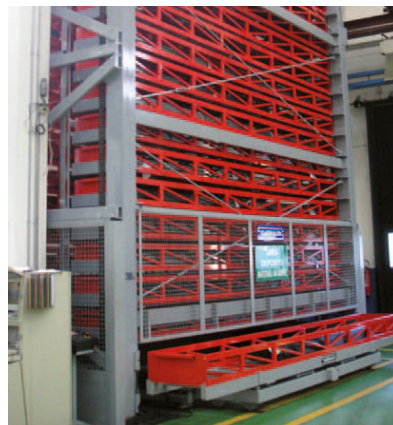
BI.MAG Behälterausgabe mit integrierter Waage BI.MAG contenant avec balance intégrée
