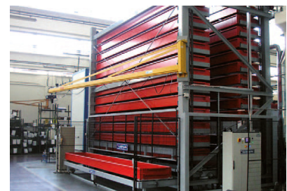
BI.MAG Anlage mit integriertem Schwenkkran BI.MAG système avec grue drapeau intégrée
