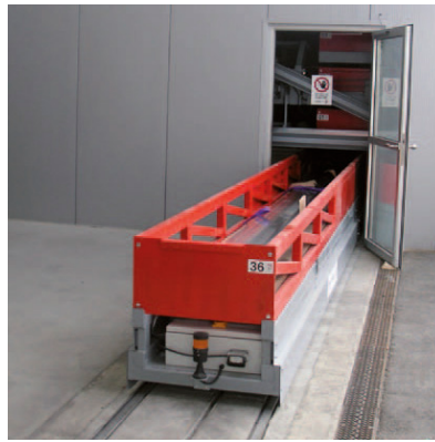
Transportschlitten lateral, schienengeführt Chariot de transport lateral sur rails
