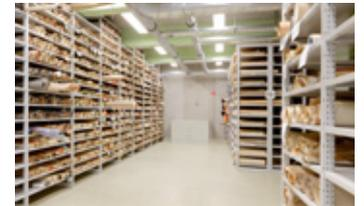
Gerollte Pläne im stationären Regal SR 409. Unterschiedliche Feldhöhen ermöglichen die optimale Ausnutzung der Raumhöhe trotz „Hindernissen“ an der Raumdecke.
