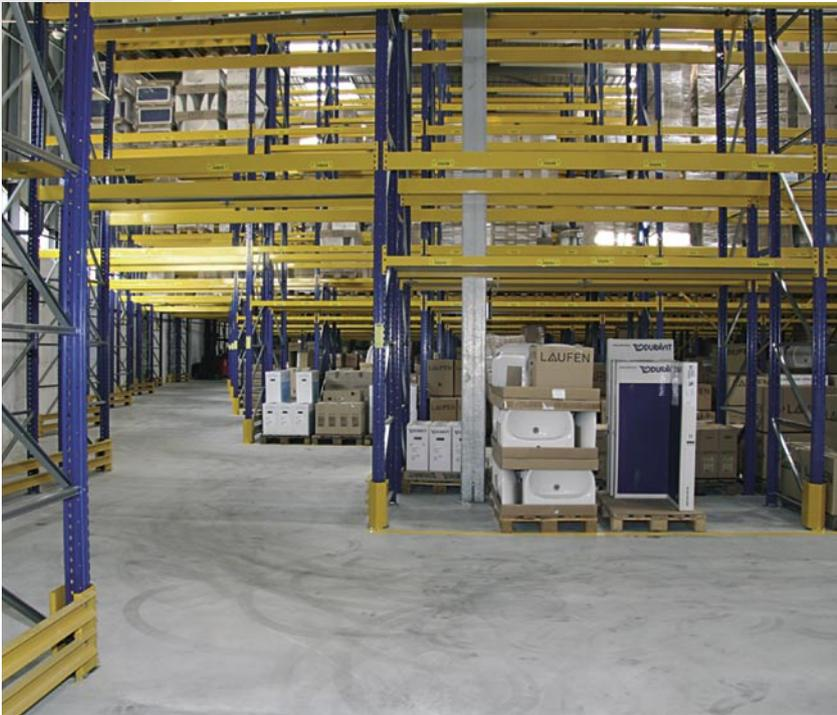
Für den optimalen Lagerumschlag wurde in der Radius-Zone die Unterfah rung für Deichsel- und Kommissionierstapler ausgelegt.
