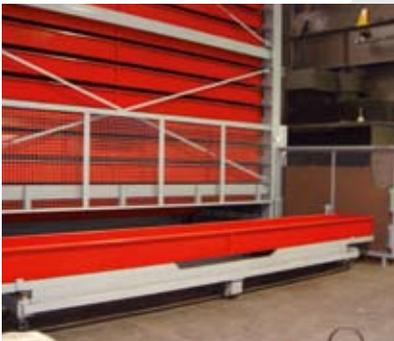
Die D.T.E. Concept GmbH schafft bei der MGC Moser-Glaser AG aus Kaiseraugst ein logistisches Raumwunder für Schwerlasten. Kernstück dieses Konzeptes bildet ein Vertikalliftsystem, wo auf 31,4 m<sup>2</sup> 104 To Langgutmaterial lagern. Damit ist dieses System eine echte Alternative zu stationären Langgutregalen, Kragarmregalen oder Verschiebeanlagen.
