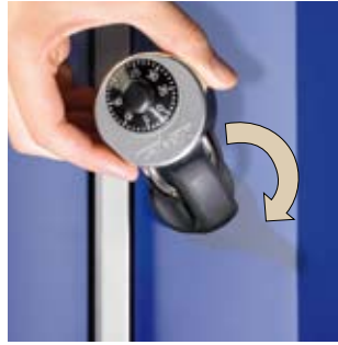
Sicherheits-Drehriegel: Ein Zerstören des Schließmechanismus durch Überdrehen ist nicht möglich, da der Schließzylinder erst mit Entfernen des Vorhangeschlusses einrastet.
