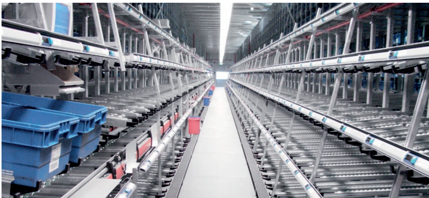
Canaux tubulaires dans l'entrepôt pour petites pièces automatique à un emplacement avec système de canal de permutation
