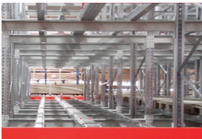
Trains de rouleaux avec rayonnage pour palettes monté, avec dispositifs de séparation centraux en raison d'une profondeur de rayonnage tubulaire importante
