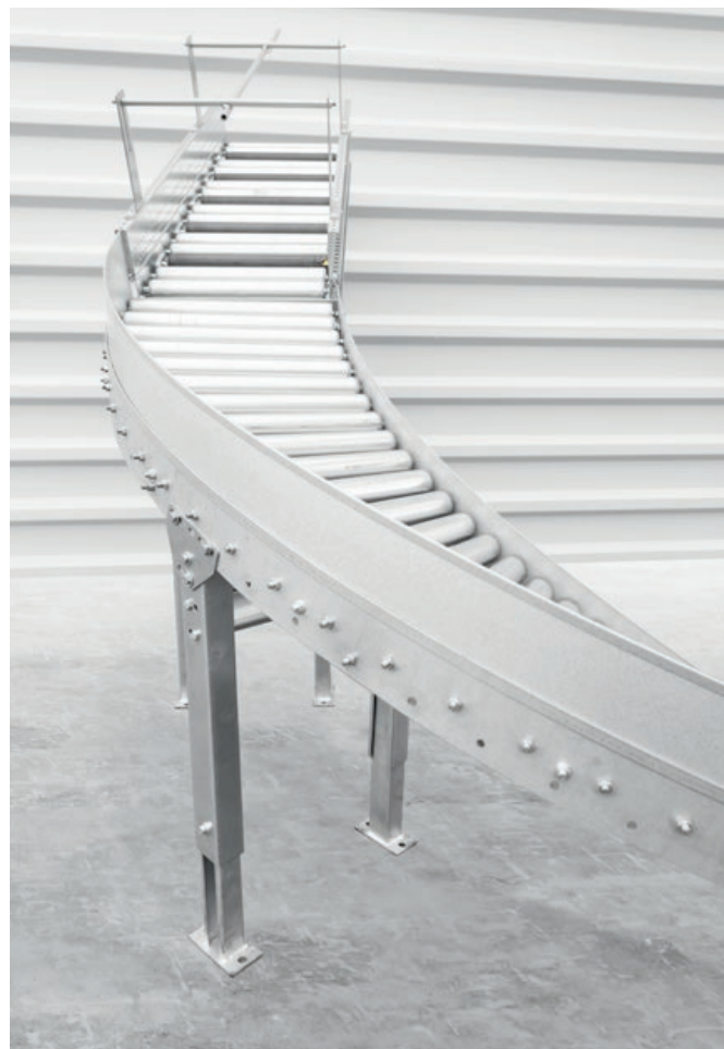
Courbe en déclin de freinage avec rouleaux porteurs et guidage latéral continu
