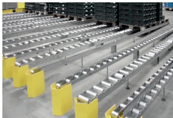
Trains de préparation de commandes à 3 pistes avec guidage latéral, accès facile au sol à des fins de nettoyage (fruits et légumes)
