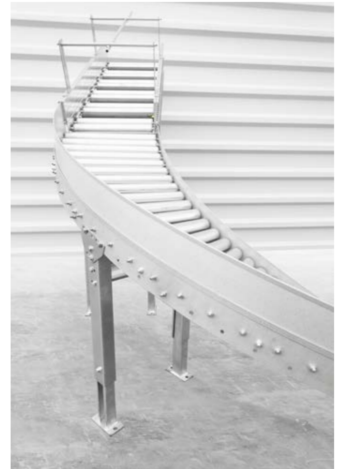
Gebremste Gefälle-Kurve mit durchgehenden Tragrollen und Seitenführung
