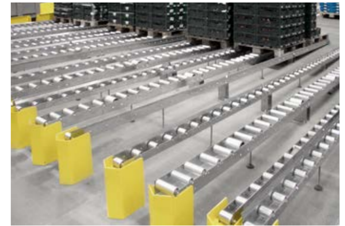
3-spurige Kommissionierbahnen mit Seitenführung, gute Zugänglichkeit des Bodens für Reinigungszwecke (Obst und Gemüse)
