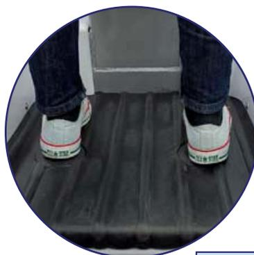
Diese Sicherheitsvorrichtungen dienen dazu, dem Bediener mit beiden Händen auf den Steuerungen eine stabile Position zu gewährleisten, bevor diese betätigt werden.
