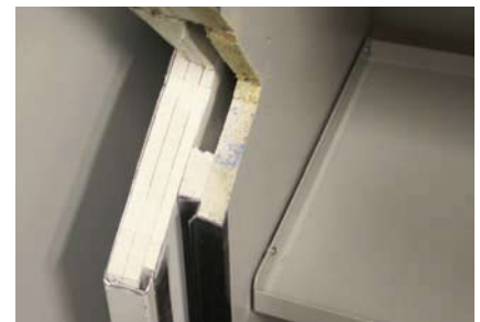
Ein üblicher Schrankaufbau der heutigen Wettbewerbsprodukte, Schrank aufgeschnitten
